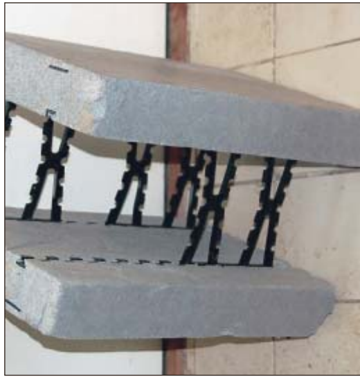
«LEGO»: Komplette blokker av EPS(ekspandert polystyren) tilsatt grafitt som brannhemmer, bundet sammen med broer av HDPE(høydensitets polyteten). Fyllt med betong er Igloveggene godkjent som brannsikre betongvegger.
